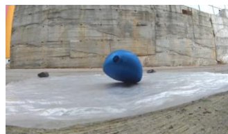
Рис. 4. Падение воздушного шарика с неньютоновской жидкостью
