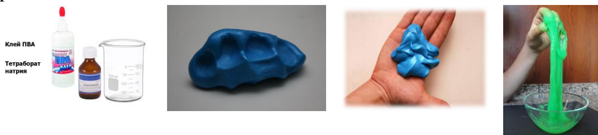
Рис. 5. “Умный” пластилин легко деформируется, после чего снова восстанавливает форму
