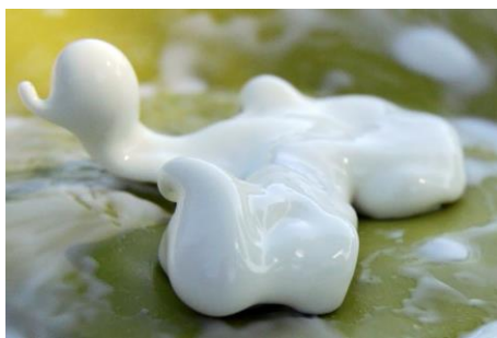
Рис. 3. При резком воздействии на поверхность раствора жидкость реагирует как твёрдое тело
