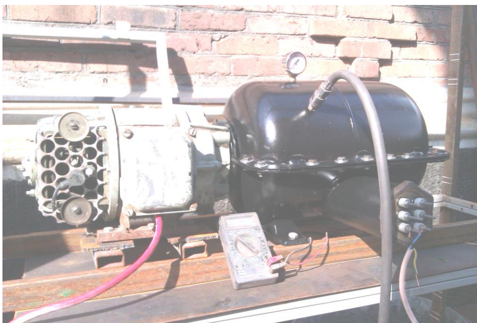
Рис. 2. Общий вид устройства для исследования манжетных уплотнений
